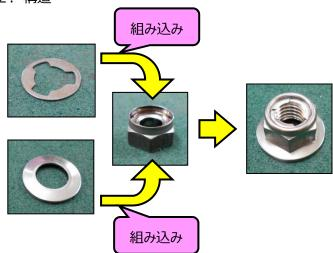
フリクションリングをナットの上面に組み込み、更に座金をナットの下面部に組み込むことで商品が完成します。
